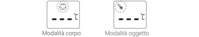
Nota: la modalità corpo viene utilizzata per misurare la temperatura della fronte e la modalità oggetto viene utilizzata per misurare la temperatura dell'oggetto.
